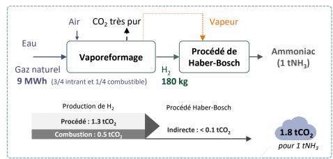
En France, l'H<sub>2</sub> est principalement produit par vaporeformage de méthane : entre 700 et 1100 °C, la vapeur d'eau réagit avec le méthane en donnant du monoxyde de carbone et de l'hydrogène. Le gaz naturel représentait **80 % des coûts de production** d'NH<sub>3</sub> en 2016, dans l'Union européenne, pour un prix moyen du gaz naturel de 4 c€/kWh. Les limites d'optimisation du processus Haber-Bosch seraient atteintes.
